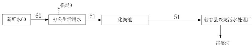
图2-1 水平衡图（单位：m<sup>3</sup>/a）
